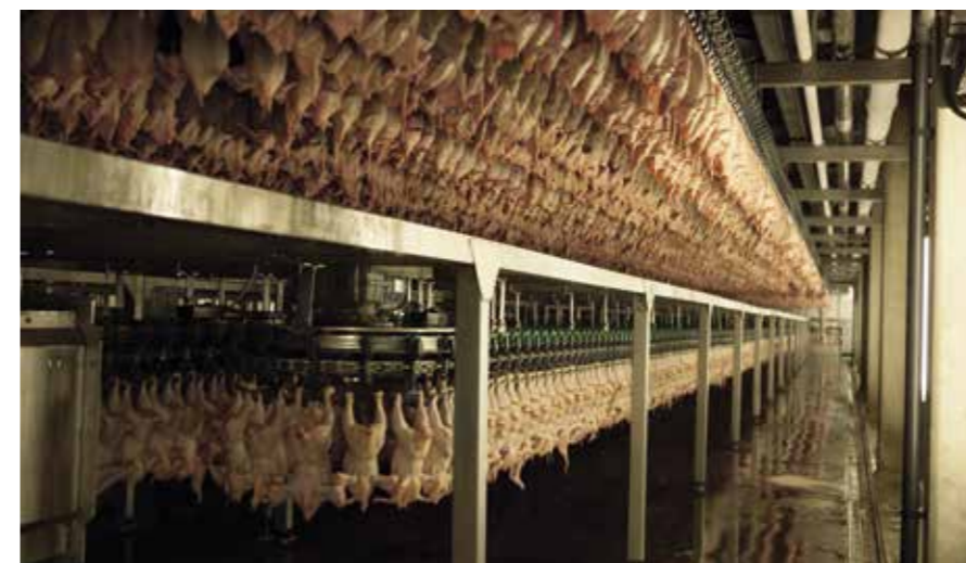
Koeltunnel in slachterij: de temperatuur wordt in ruim 3,5 uur teruggebracht naar circa 2 tot 4 graden Celsius.
